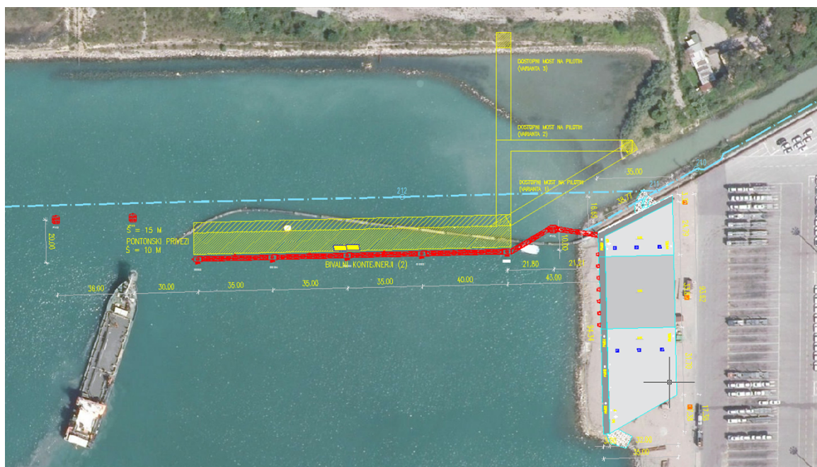
Slika 3: predlog prostorske umestitve pontonskih privezov in pontonskih dostopnih mostov (kartografska podlaga: PID projektna dokumentacija RO-RO VEZ V BAZENU III (I. faza), št proj. Gp-pr-6/20, GEOPORTAL d.o.o. Ljubljana.)
